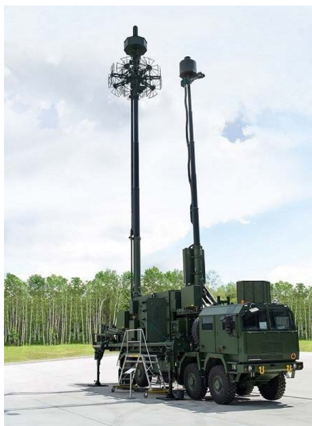
Prototyp eines militärischen Passiv-Radars der polnischen Firma PIT-RADWAR S.A www.pitradwar.com
